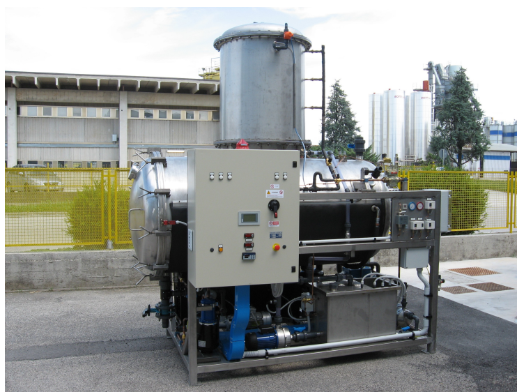
Modello CVD 50 (anno 2008) Portata oraria del distillato 50 lt/h.
