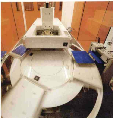
Una fase della produzione delle celle: stampa e l'asciugatura dei contatti frontali.
