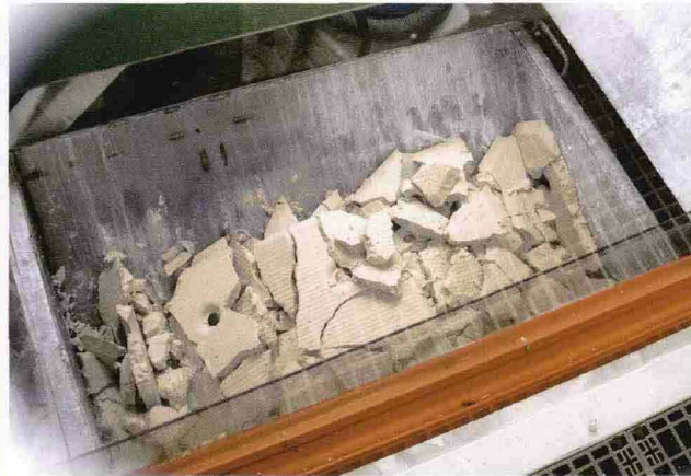
Il risultato del ciclo dei reflui concentrati con l'impianto IWT è una piccola percentuale di fango inerte che viene compattato e asciugato.
