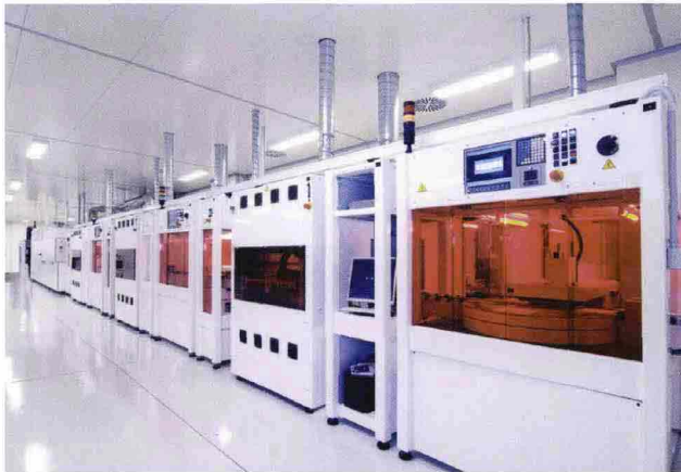
La linea celle da 30 MWp installata da Helios Technology nel proprio stabilimento produttivo di Carmignano in Brenta.
