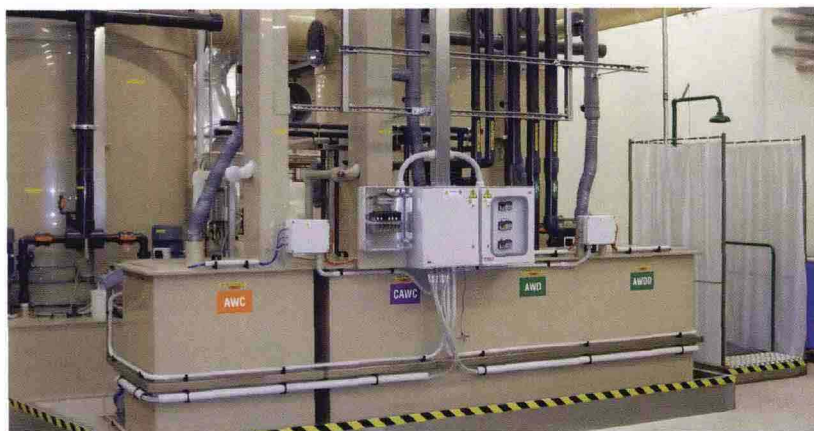
Le vasche dove avviene la separazione dei fluidi di processo per i successivi trattamenti.
